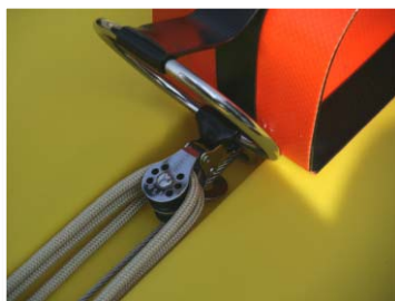
Aufzugssystem mit 4 zu 1 Flaschenzug
